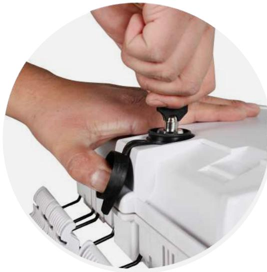
2. Retire los puertos de entrada de la caja para poder ingresar el cable que se desea instalar.
